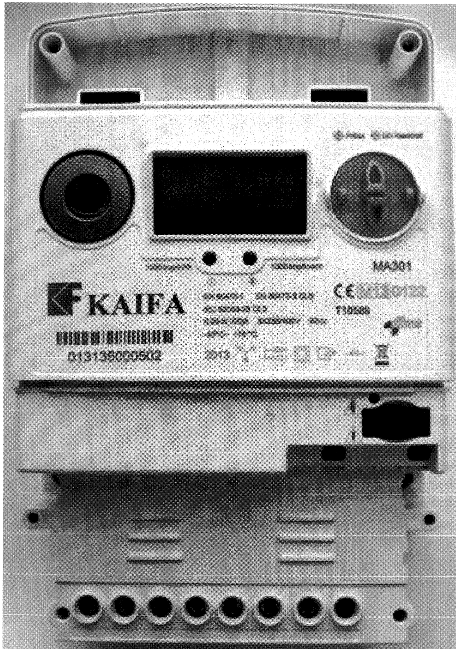
Slika 10: brojilo KAIFA MA110 bez poklopca priključnice i komunikacijskog modula
